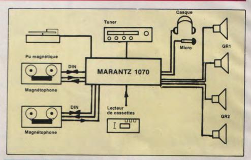
Il offre la possibilité de raccorder quatre enceintes acoustiques pour l'écoute en stéréophonie ou en ambiophonie grâce à une commutation située à l'arrière de l'appareil, à proximité des bornes de raccordement de ces enceintes. De plus, il est prévu, et ceci grâce à la présence de deux jeux de prises pour enregistrement-lecture, d'effectuer de la copie de bande magnétique au moyen des deux magnétophones qu'il est possible de raccorder.
